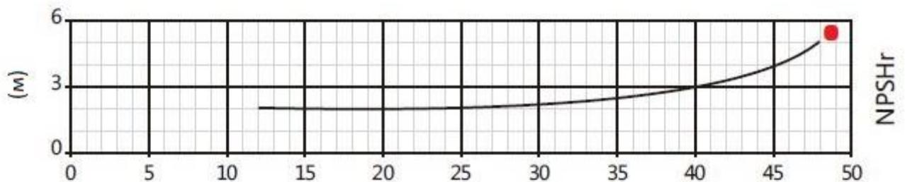
Пояснение к графикам: H – напор в м.в.с., Q – подача в м³/ч, NPSHr – потери давления на всасывании, кВт – потребляемая мощность в кВт. Измерения проводились для чистой воды, температурой 20°С и вязкостью 1 мм²/с
